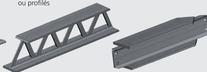
Structure en tubes ou profilés
