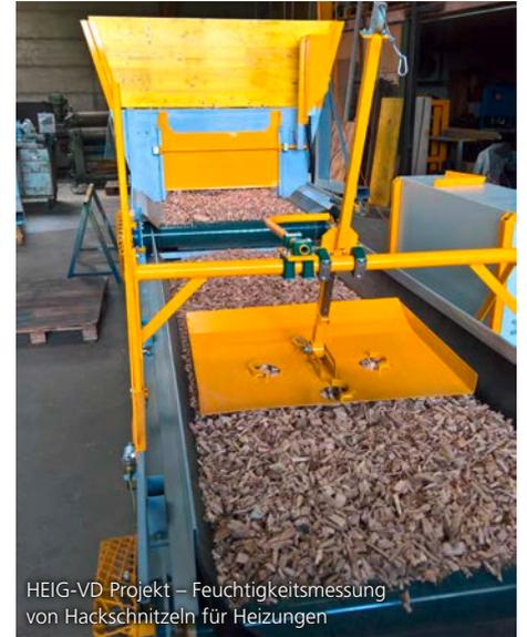
HEIG-VD Projekt – Feuchtigkeitsmessung von Hackschnitzeln für Heizungen
