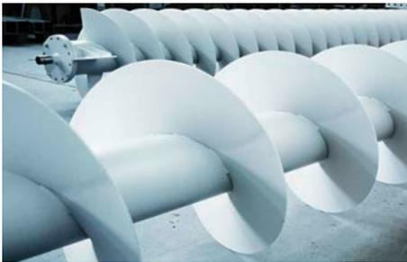
Schneckenflügel bzw. Förderschnecken kommen meist beim Transportieren/Fördern vom staubförmigen, körnigen und faserigen Stoffen zum Einsatz. Förderschnecken können, zum Beispiel bei der Betonförderung, auch als Mischer während der Förderung angewendet werden.
