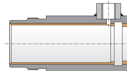
Les tubes BIMETAL sont usinables sur l'extérieur comme l'intérieur avec les procédés standards d'usinage – il est possible de traverser les deux couches – et souder des pièces sur l'extérieur.
